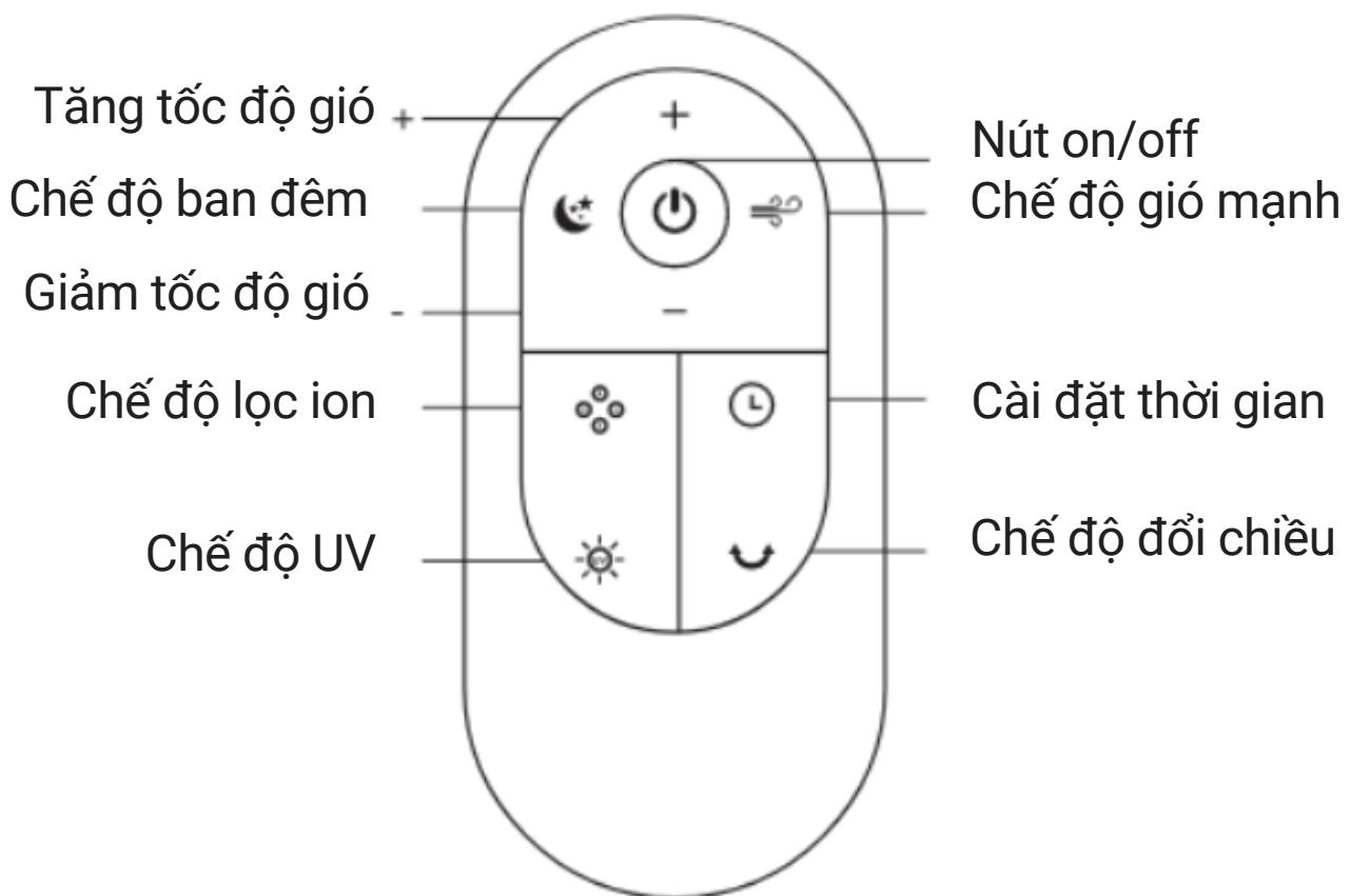
Khi sử dụng điều khiển từ xa để thao tác, cần cẩn chỉnh điều khiển từ xa với bộ nhận tín hiệu điều khiển từ xa trên màn hình hiển thị để đạt được tín hiệu điều khiển từ xa tốt nhất.
